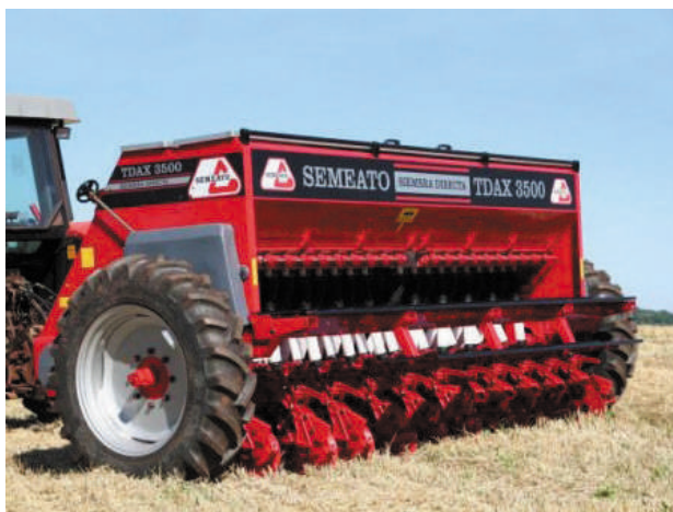
Figura 12. Semeadora para sementes finas utilizada na implantação do capim em operação independente. Foto: Semeato/Divulgação.
