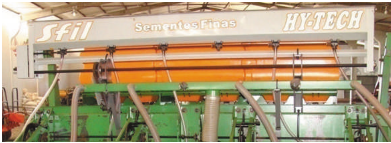
Figura 14. Semeadora com terceira caixa original. Foto: Fundação MS.
