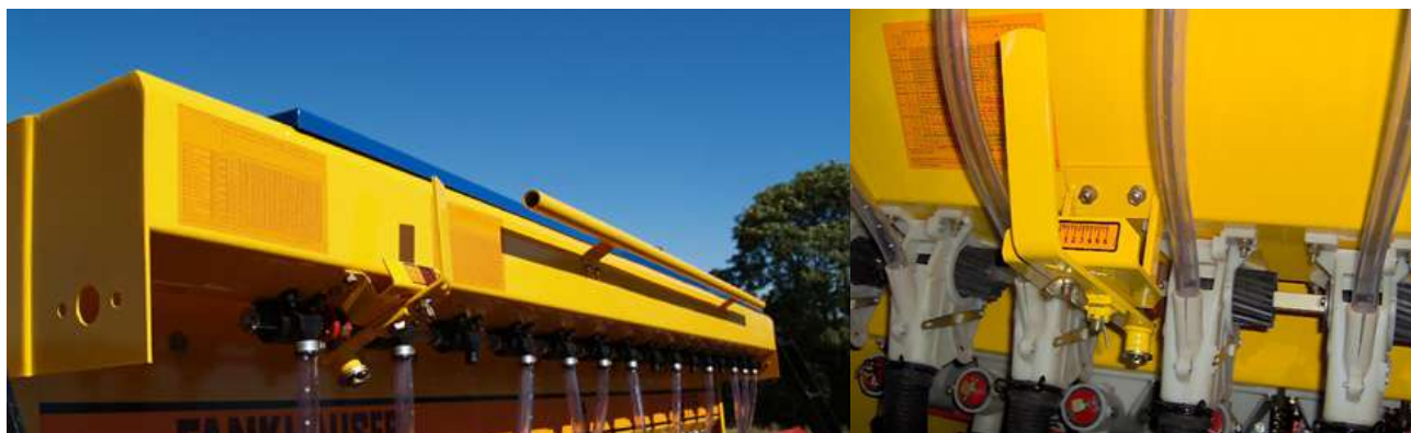
Figura 15. Semeadora com terceira caixa, com uma mangueira por linha de plantio posicionada após o carrinho de plantio. Foto: Fankhauser/Divulgação.
