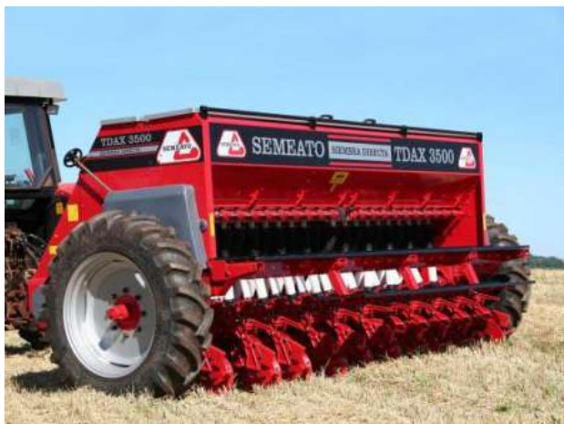
Figura 12. Semeadora para sementes finas utilizada na implantação do capim em operação independente. Foto: Semeato/Divulgação.
